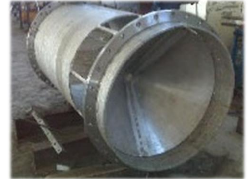
Proceso de fabricación de válvula tipo Howell - Bunger de 1.000 mm de diámetro para la Central Hidroeléctrica de Valdetales (Canal de Isabel II – Hidráulica Santillana)
