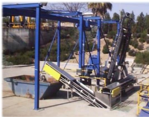
Limpiarrejas basculante en la EDAR San Jerónimo. Emasesa
