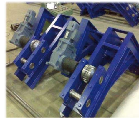
Accionamientos de los limpiarrejas lineales de entrada de agua a la balsa de La Restinga. Confederación Hidrográfica del Guadalquivir
